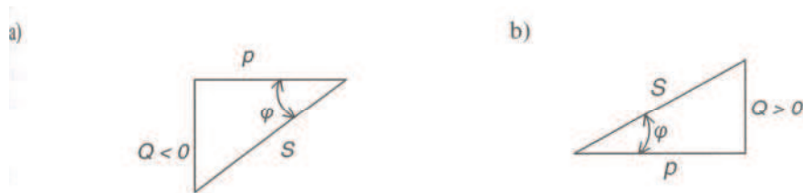
Rys.17. Trójkąty mocy: a) odbiornik pojemnościowy, b) odbiornik indukcyjny [1,s.200]
