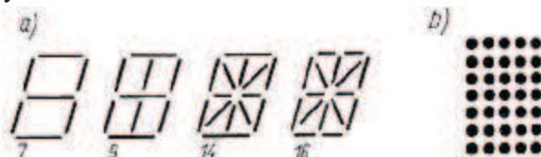
Rys.25. Struktury wskaźników półprzewodnikowych: a) segmentowe; b) mozaikowe [1,s.458]
