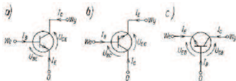
Rys. 8. Układy pracy tranzystorów oraz strzałkowanie prądów i napięć: a) układ wspólnego emitera WE; b) układ wspólnego kolektora WC; c) układ wspólnej bazy WB [1,s.150]
