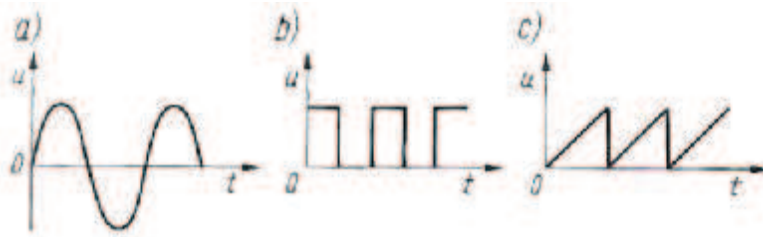
Rys.57. Typowe przebiegi napięć generatorów: a) sinusoidalnych; b) prostokątnych; c) piłokształtnych. [1,s.250]
