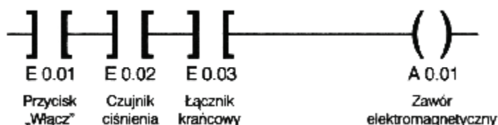
Rys. 49. Schemat stykowy KOP [14, s. 11]
