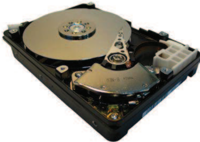
Rys. 12. Widok dysku twardego po zdjęciu pokrywy [12]
