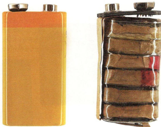
Rys. 2.104. Bateria 9 V, po prawej – bateria bez obudowy (widać 6 ogniw 1,5 V); czasem zamiast ogniw pastylkowych stosuje się 6 ogniw o rozmiarze AAA
