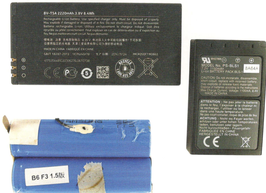
Rys. 2.102. Ogniwa litowo-jonowe: u góry – ogniwo płaskie, po prawej – ogniwo blokowe (prostokątne), na dole – fragment zestawu ogniwo od notebooka (widoczny przyklejony czujnik temperatury)
