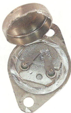
Rys. 2.13. Obudowa TO-3 ze zdjętą osłoną; widoczne wnętrze tranzystora
