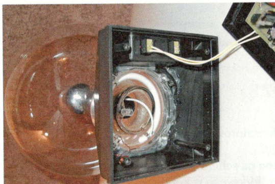
Rys. 2.49. Przykład transformatora Tesli użytego do budowy kuli plazmowej
