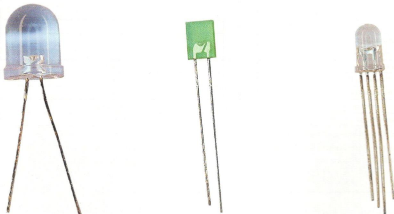
Rys. 2.61. Diody LED: po lewej – biała w obudowie o średnicy 10 mm, na środku – zielona w obudowie barwionej, po prawej – dioda RGB
