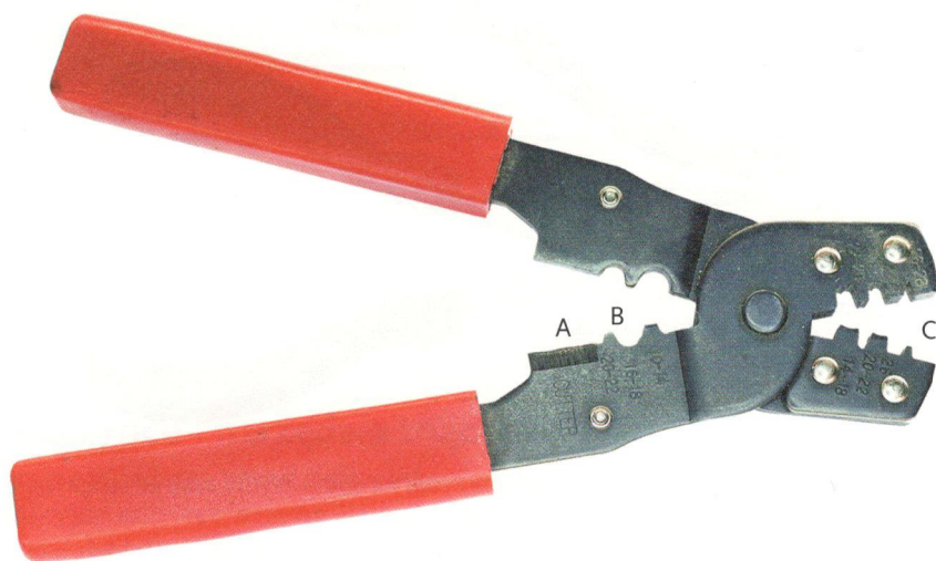
Rys. 3.14. Przykładowa prasa uniwersalna: A – nóż do cięcia przewodów, B – szczęki konektorów izolowanych, C – szczęki do konektorów DWG 14-28
