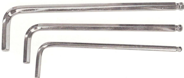
Rys. 3.5. Przykłady kluczy imbusowych; z prawej strony widoczne podcięcie umożliwiające pracę narzędzia pod kątem
