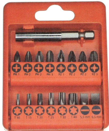
Rys. 3.2. Zestaw bitów; widoczne oznaczenia typu grotu i rysunki poglądowe
