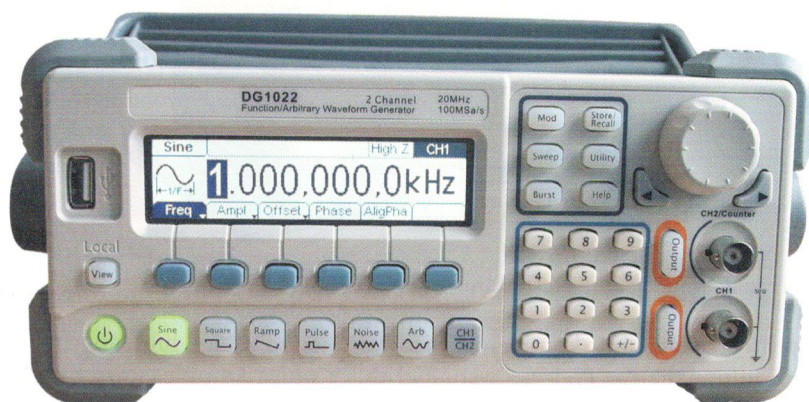
Rys. 3.40. Przykład generatora arbitralnego laboratoryjnego z portem USB do wgrzywania przebiegów zdefiniowanych przez użytkownika
