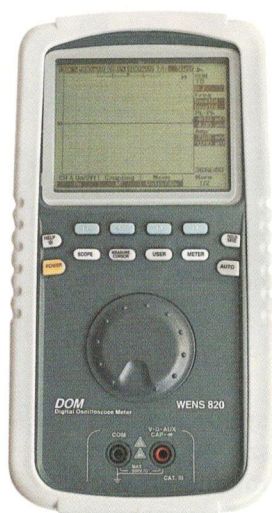
Rys. 3.38. Przykład oscyloskopu przenośnego wielkości multimetru, odgrywającego jego rolę (pomiar napięcia, rezystancji, pojemności i tester diod) – maksymalna obsługiwana częstotliwość to 20 MHz
