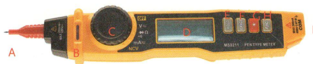
Rys. 3.35. Multimetr długopisowy: A – grot (+), B – kontrolka wysokiego napięcia, C – pokrętło wyboru trybu pracy, D – wyświetlacz LCD, E–H – przyciski sterujące, I – wyjście sondy (–)
