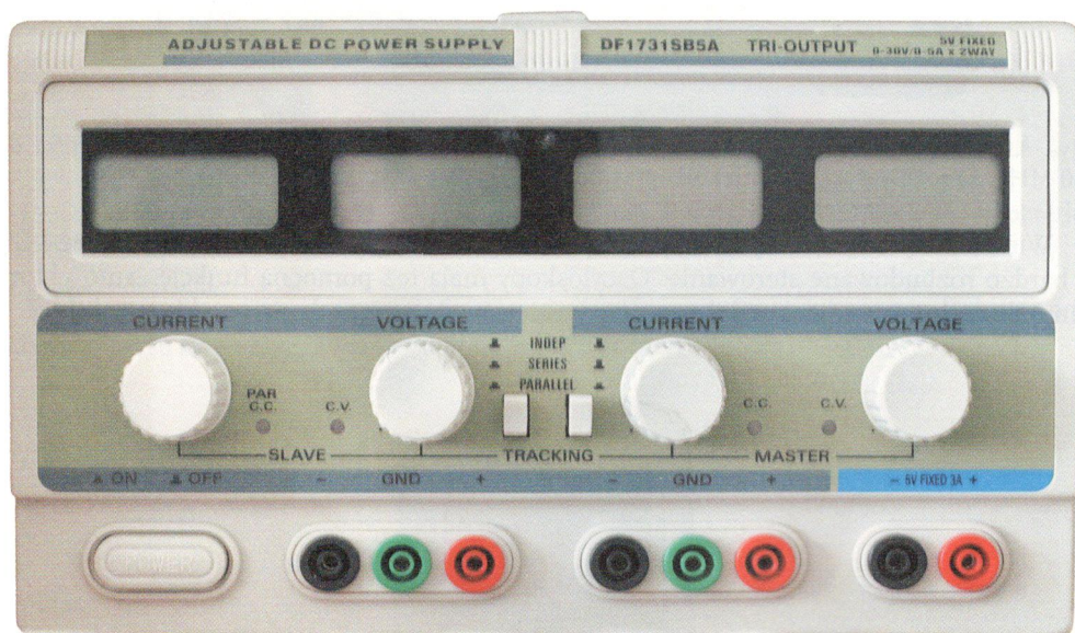
Rys. 3.39. Przykład zasilacza laboratoryjnego dwukanałowego z dodatkowym wyjściem 5 V, z możliwością regulacji napięcia i prądu
