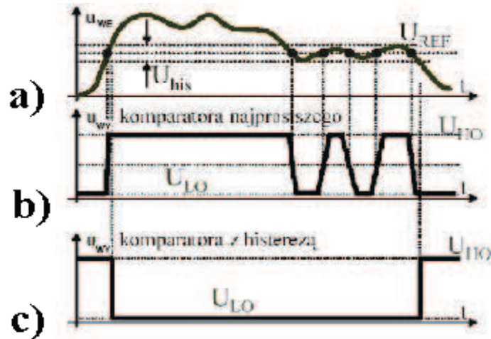
Rys. 15. Zasada pracy komparatora z histerezą. a) przebieg wejściowy, b) przebieg wyjściowy bez histerezy, c) przebieg wyjściowy z histerezą [12]
