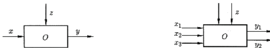
Rys. 1. Obiekt sterowania: a) o jednym sygnale wejściowym i wyjściowym, b) o wielu sygnal wejściowych i wyjściowych [6, s. 6]
