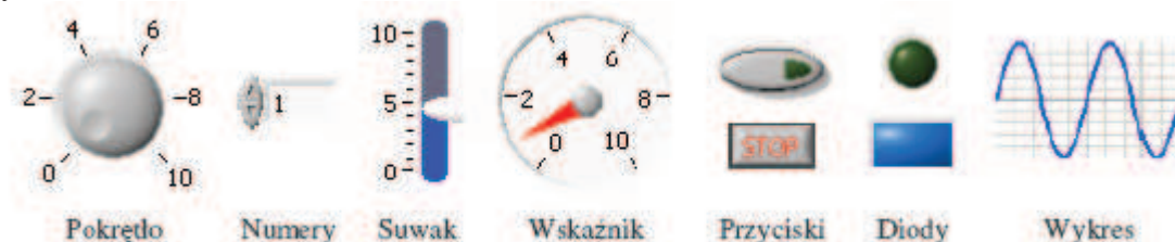
Rys. 23. Przykłady kontroltek używanych w środowisku LabVIEW [7]
