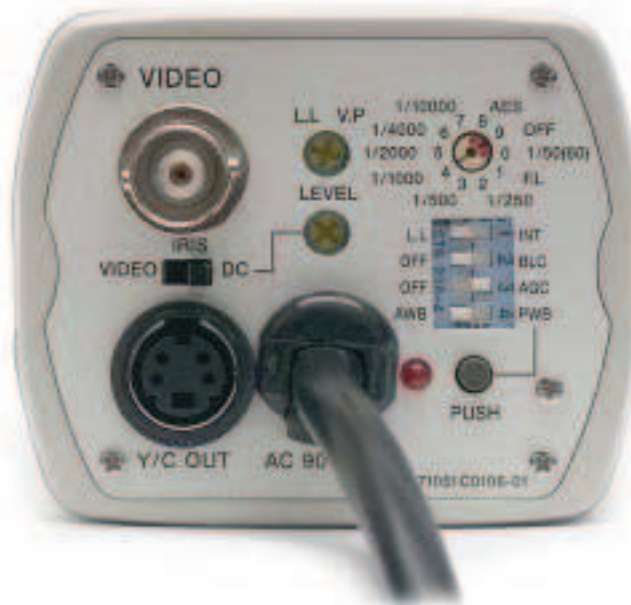
Rys. 7. Widok tylnej ścianki kamery (złącza i przełączniki) [1]
