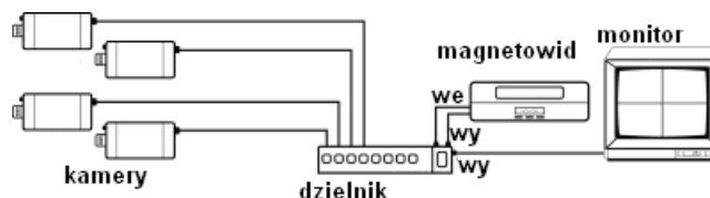
Rys. 4. System z możliwością rejestracji obrazu z kilku kamer [1].
