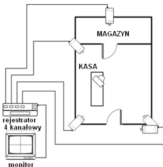
Rys. 5. System telewizji użytkowej w małym sklepie [1]
