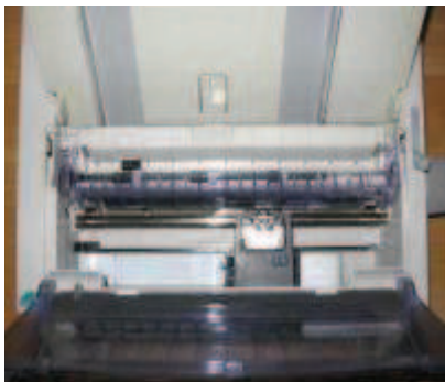
Rys. 7. Wnętrze drukarki widoczne wałki i głowica drukująca z taśmą barwiącą.
